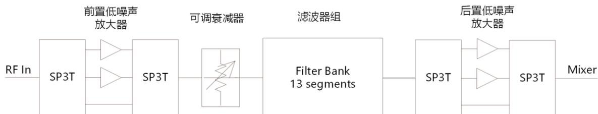
SAE-90 共设置了 13 段变频通道预选滤波器与 1 段直接采样通道抗混叠滤波器，各频段频率范围如下表所示：
